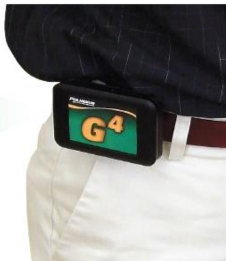
G4 は磁気を利用した3次元磁気式位置測定装置です。このシステムはソースとなる磁界発生源、センサとなる磁力計測部さらにそれらを制御するコントローラーで構成された6自由度測定装置です。この磁気式センサは、光学式、音波式やカメラ式とは違い、物理的な障害物に影響されずにデータをリアルタイムで提供致します。またワイヤレスなのでケーブルが絡まず、回転を伴う運動などの解析に適しています。
